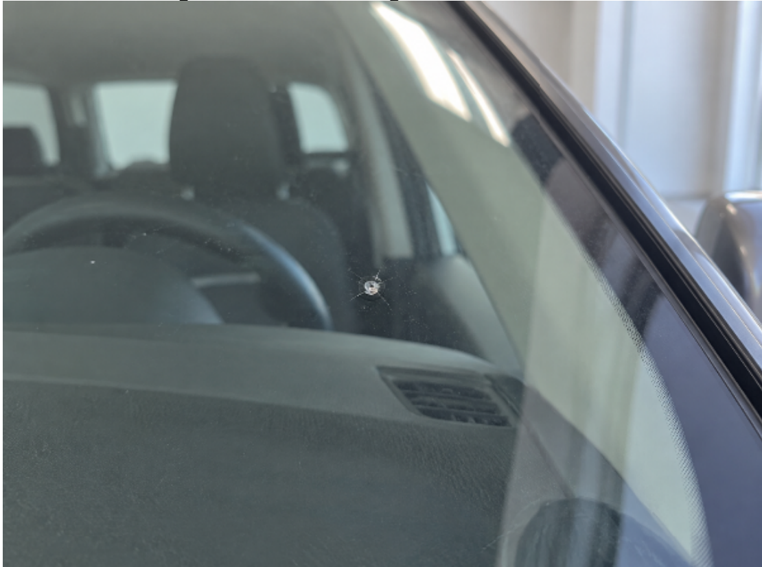
Schadensmarkierungen Scheibe: Steinschlag
